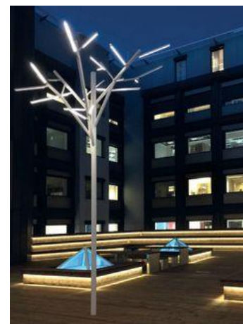
Figuras 5, 6 e 7 – Luminária com 3 pétalas com fontes LED's e apoio intermediário para objetos e pontos de carga para celulares. E poste "árvore" com várias pétalas (braços) com fontes LED's. Fonte: LED Decorative lighting ALBERO by iGuzzini Illuminazione
