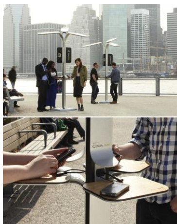
Figuras 5, 6 e 7 – Luminária com 3 pétalas com fontes LED's e apoio intermediário para objetos e pontos de carga para celulares. E poste "árvore" com várias pétalas (braços) com fontes LED's. Fonte: LED Decorative lighting ALBERO by iGuzzini Illuminazione
