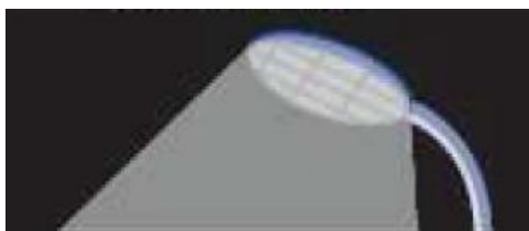
Figuras 19 – Luminária (projektor) em poste com fonte LED e sua distribuição fotométrica (isocandelas) na superfície (plano horizontal) da via. Fonte: O Emprego da Tecnologia LED na Iluminação Pública – Ana Cristina Cota Ribeiro, Helbert Carlos Pinto Rosa, Joana D'Arque da Silva Correa e Arlete Vieira da Silva. Fonte: WHITAKER, 2006.
