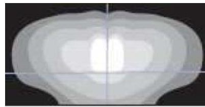
Figuras 18 – Luminária (projektor) em poste com fonte Vapor de Sódio e sua distribuição fotométrica (isocandelas) na superfície (plano horizontal) da via.
