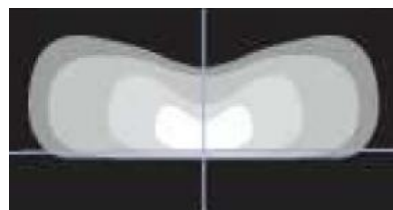
Figuras 19 – Luminária (projektor) em poste com fonte LED e sua distribuição fotométrica (isocandelas) na superfície (plano horizontal) da via. Fonte: O Emprego da Tecnologia LED na Iluminação Pública – Ana Cristina Cota Ribeiro, Helbert Carlos Pinto Rosa, Joana D'Arque da Silva Correa e Arlete Vieira da Silva. Fonte: WHITAKER, 2006.
