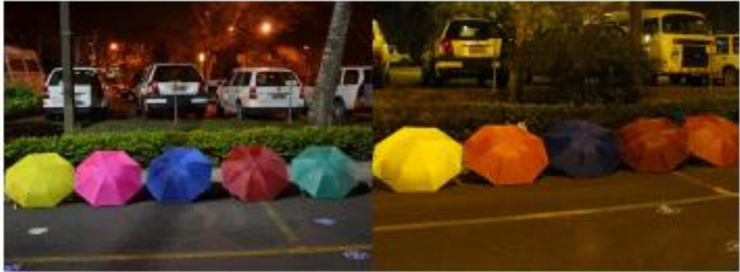
Comparativo entre duas fontes luminosas com diferentes IRC's Fonte: COPEL e GE - General Eletric (2011)
